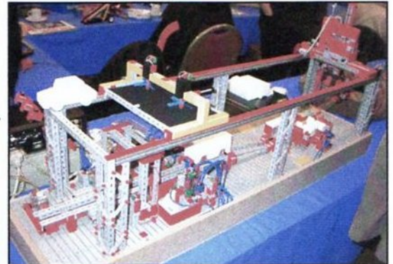
Links: Het pronkstuk van Andries Tielaman: Een hopperzuiger die met maar liefst vier interfaces werd aangestuurd. De zuigarm kon geheel worden neergelaten en de bodem van de boot kon pneumatisch worden geopend.
