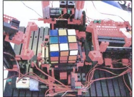
Rechts: Onder aansturing van ROBO Pro software, de "Cube Solver" van Markus Mack.
