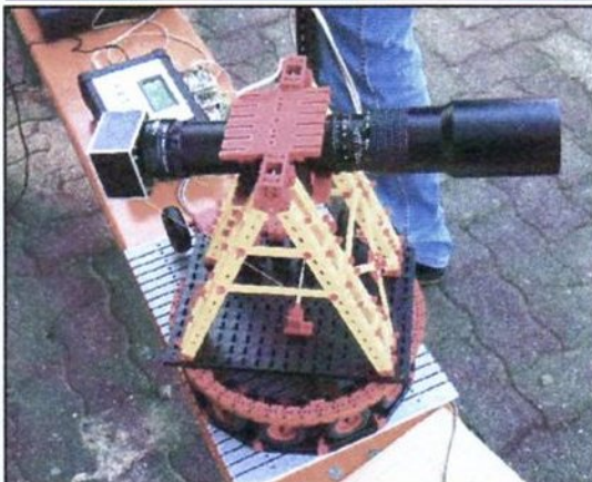
Links: Bestuurbare telescoop met beeldsensor van Martin Romann. Het beeld was op een laptop te zien. (Foto: Joachim Jacobi)
