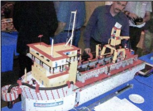
Links: Het pronkstuk van Andries Tielaman: Een hopperzuiger die met maar liefst vier interfaces werd aangestuurd. De zuigarm kon geheel worden neergelaten en de bodem van de boot kon pneumatisch worden geopend.
