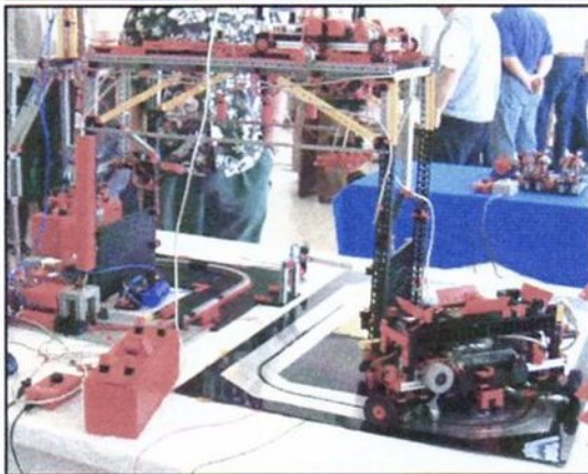
Links: Portaalkraan met transportbaan die zelf zijn weg zoekt m.b.v. lichtsensoren van Markus Pütter.
